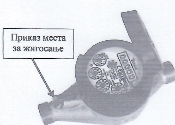
Слика 5. Спољашњи изглед водомера ознаке типа VVS-G и приказ места жигосања
